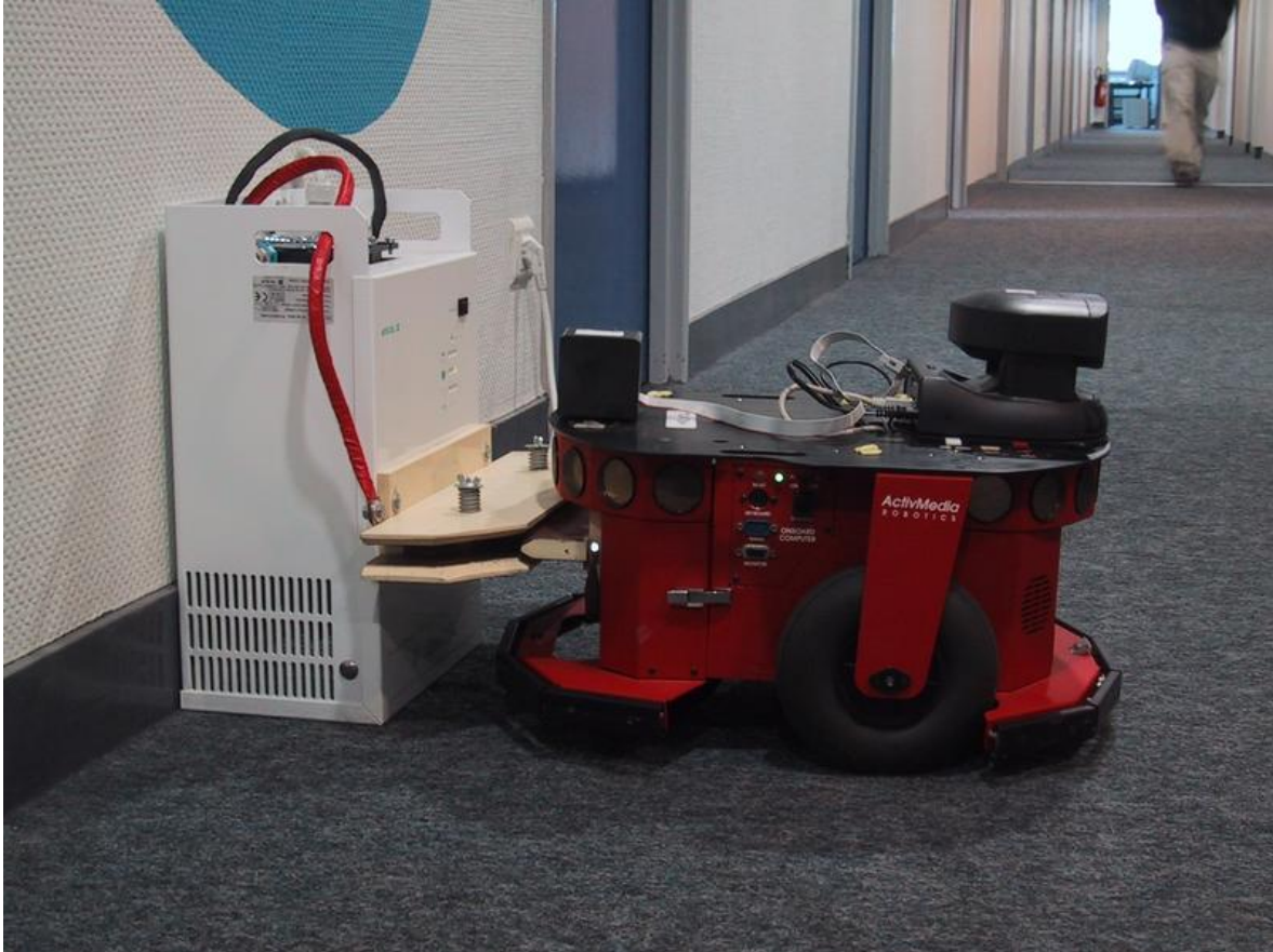
FIG. 9.1: Un robot Pioneer 2 connecté à une station de recharge. Le contact est assuré par deux larges lames de cuivre, au-dessus et en dessous d'un becquet. Le robot peut se connecter sans intervention manuelle à condition qu'il vise suffisamment bien.
